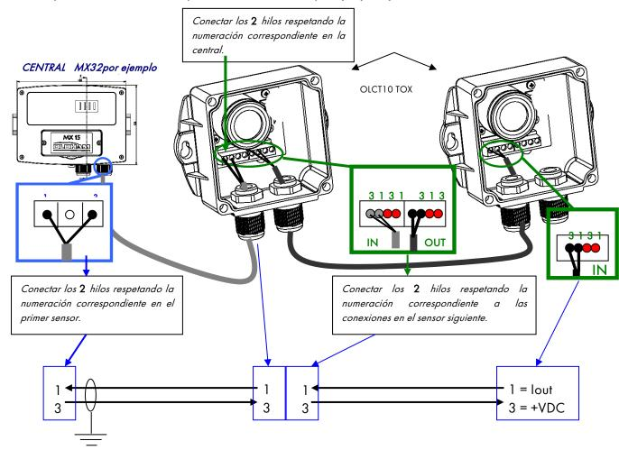
Nota: los bornes • que quedan libres permiten la conexión de **otra** red de transmisores OLCT10 TOX de idéntica naturaleza o destinados a la detección de un gas diferente (caso del CO/NOx en los aparcamientos).
