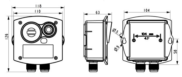
Para la fijación, taladrar dos orificios a 104 mm de intervalo en el soporte.
